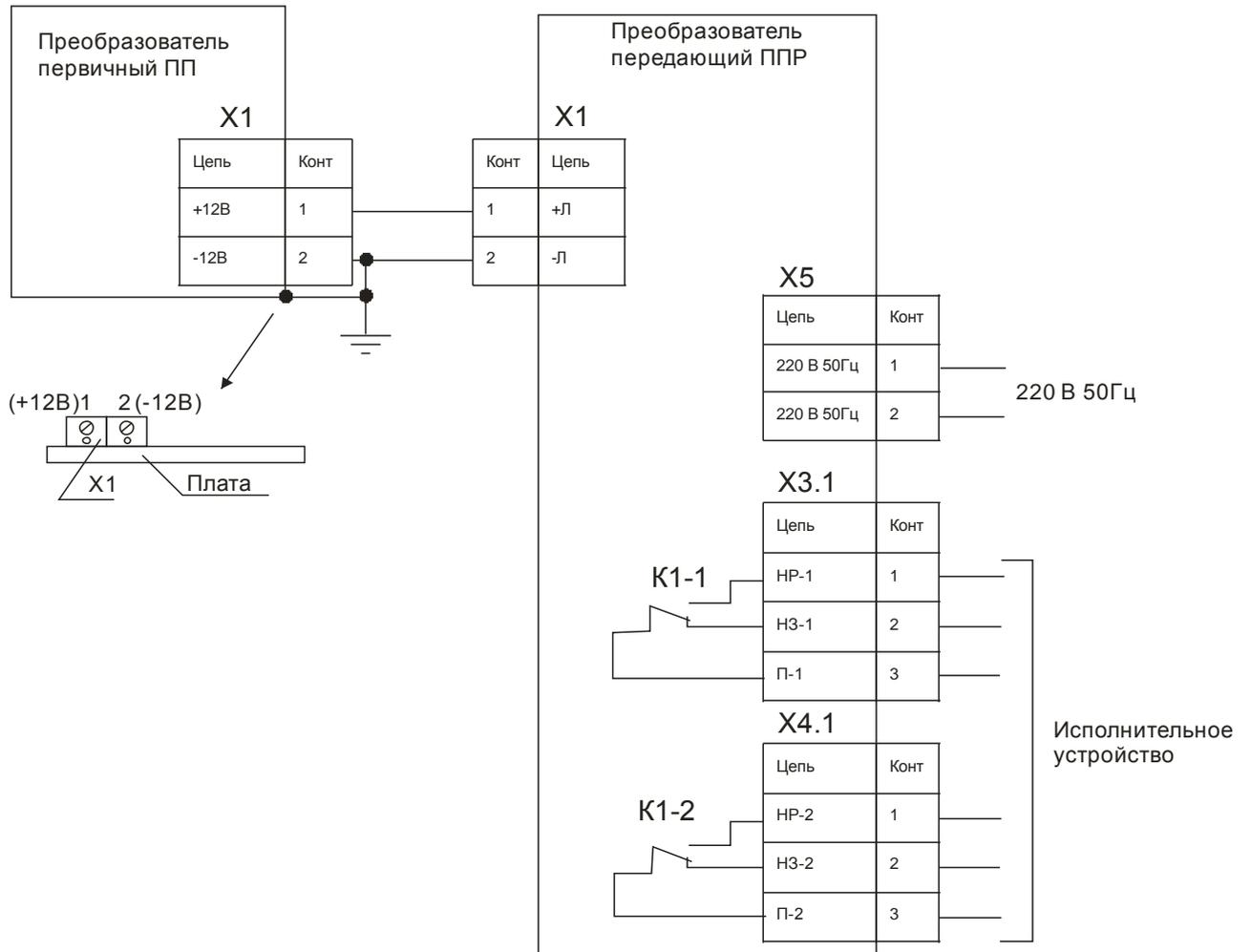
Рис. В.2 - Схема подключения УЗР-1 (невзрывозащищенное исполнение)
