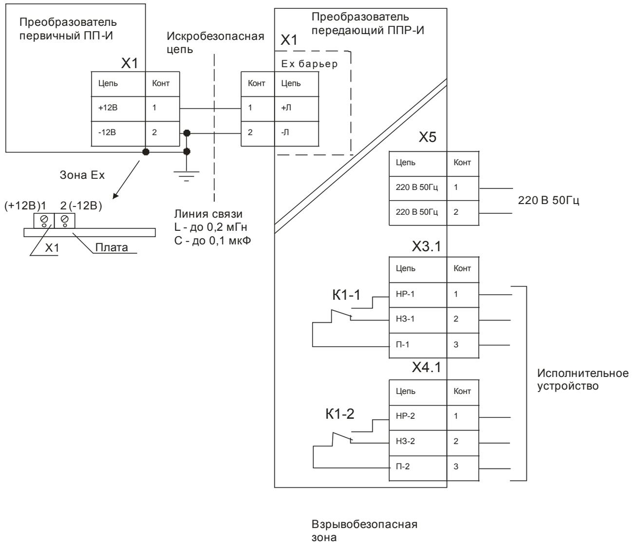
Рис. В.1 - Схема подключения УЗР-1И (взрывозащищенное исполнение)
