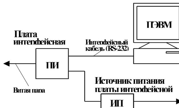
Рис. 12. Схема подключения центрального компьютера.
