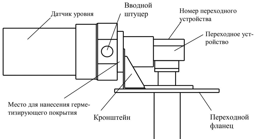
Рис.7. Внешний вид крепления датчика на переходном устройстве.
