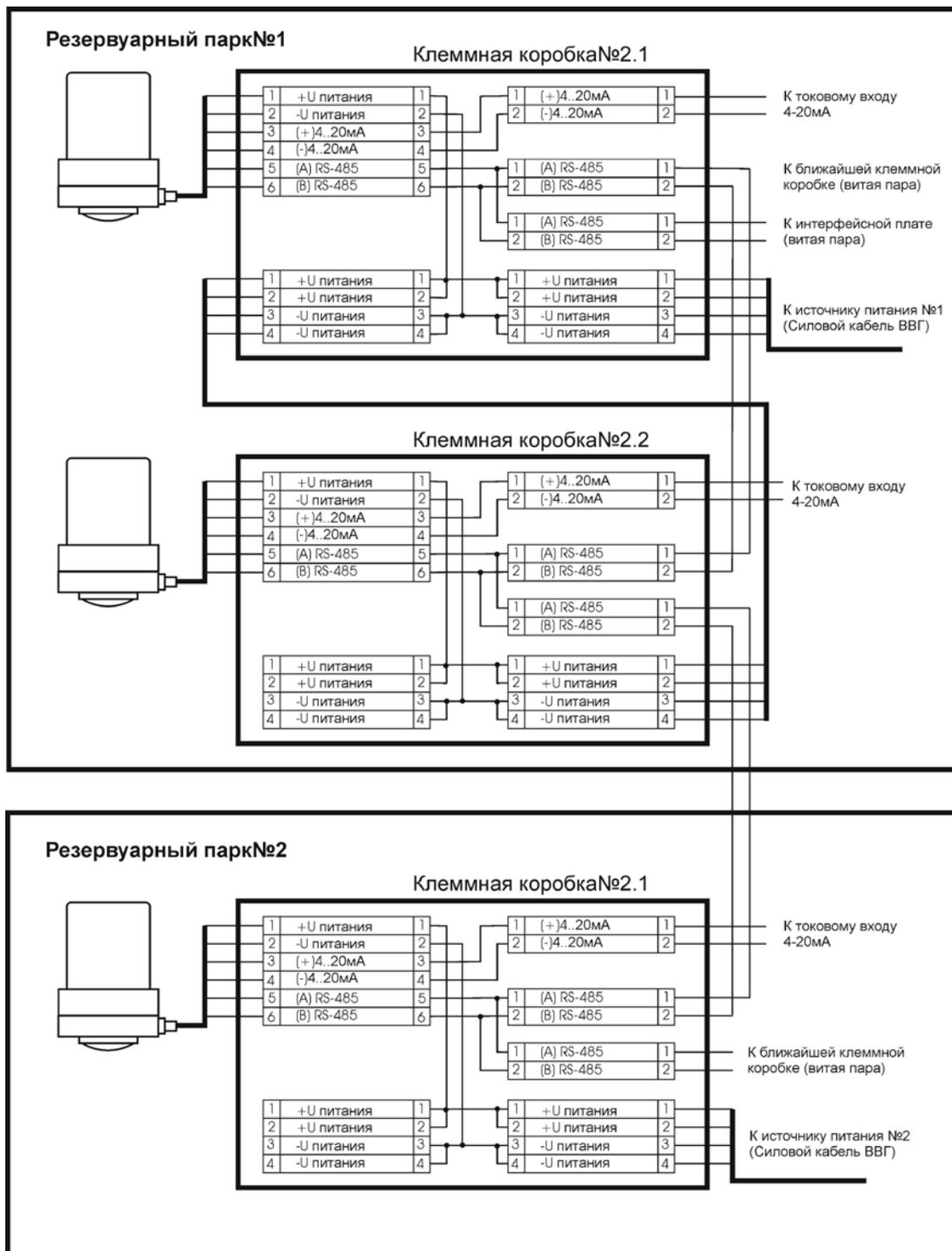
Рис. 11. Вариант подключения датчика с выделенным источником питания.
