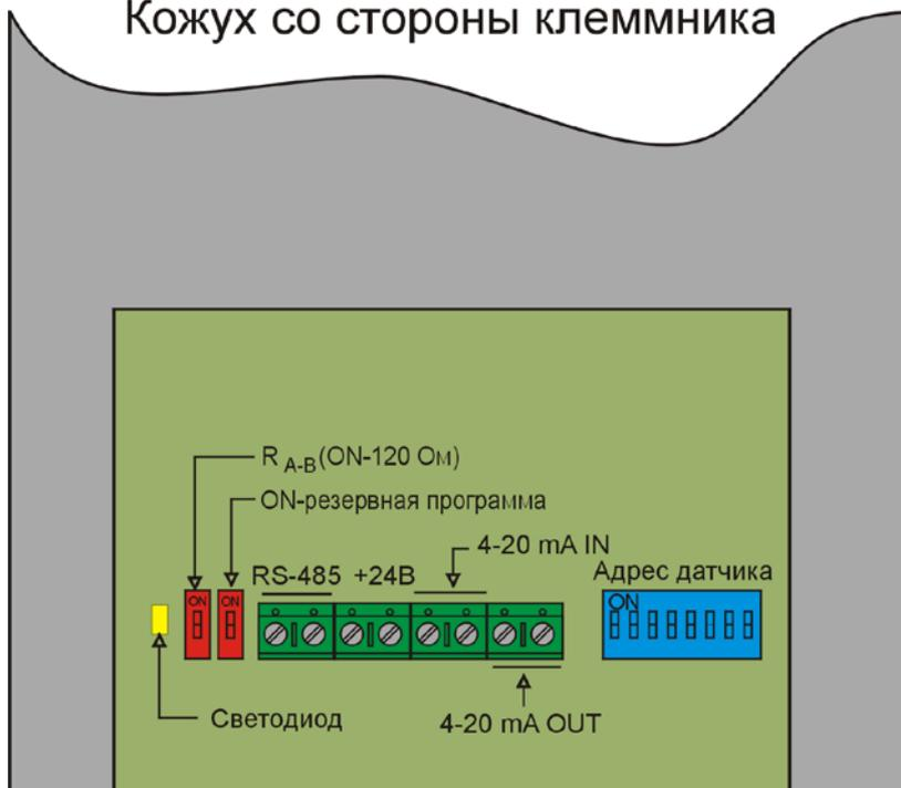
Рис. 9.А Подключение кабеля к клеммной колодке датчика.
