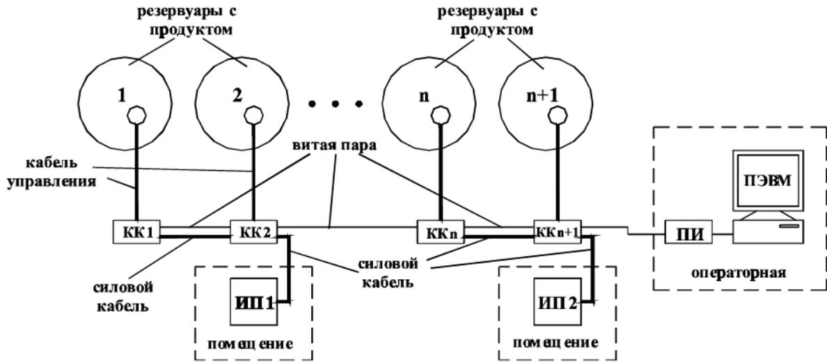
Рис. 3. Включение уровнемера с несколькими источниками питания.
