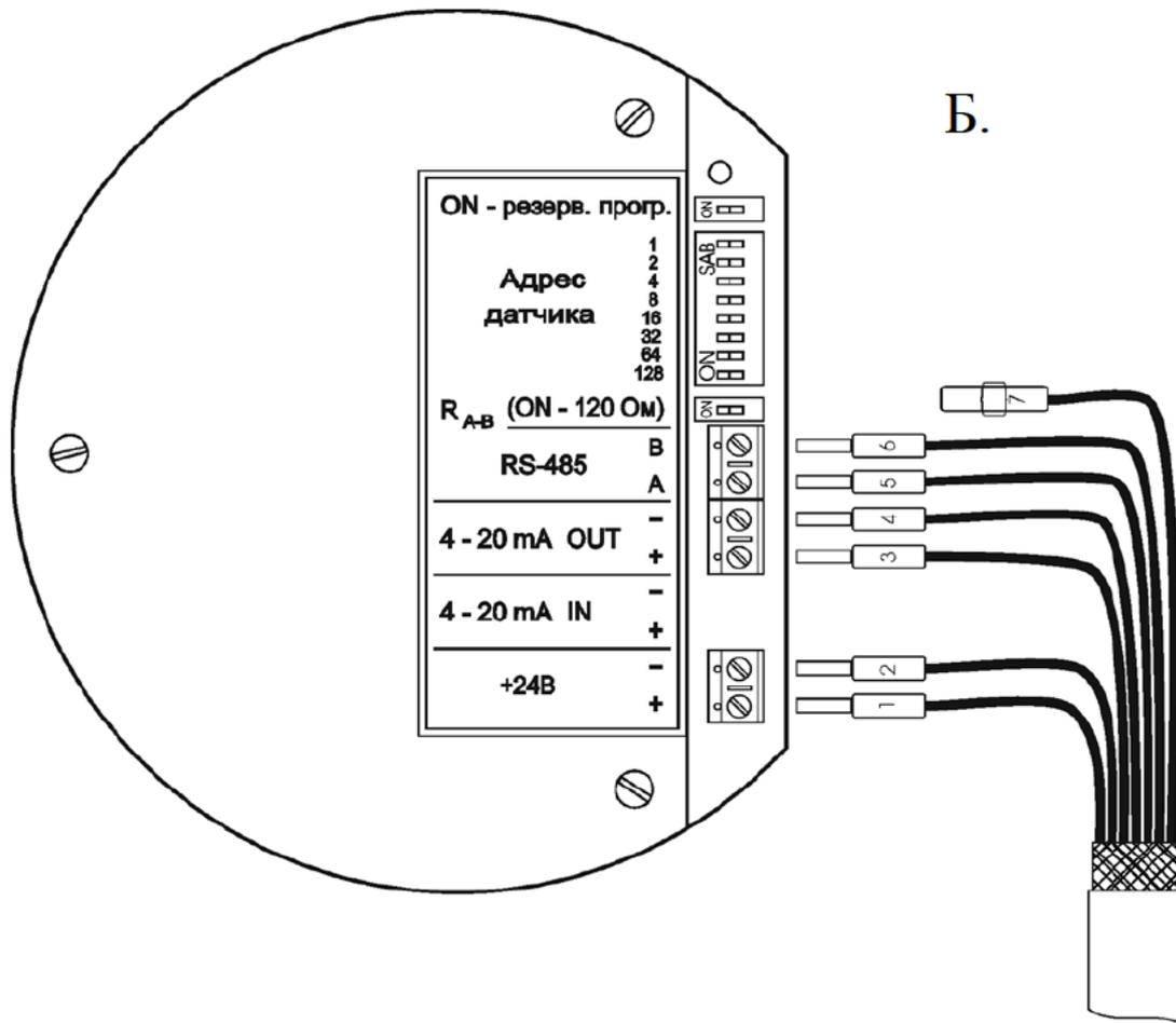
Рис. 9.Б Подключение кабеля к клеммной колодке датчика.
