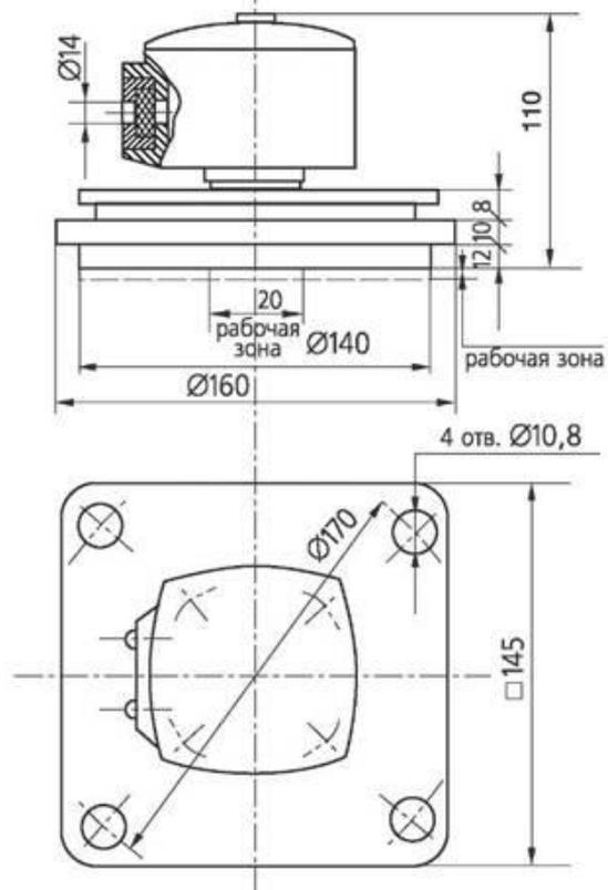
Рис. 5. Общий вид, габаритные и установочные размеры СУС-181Р(Б)
