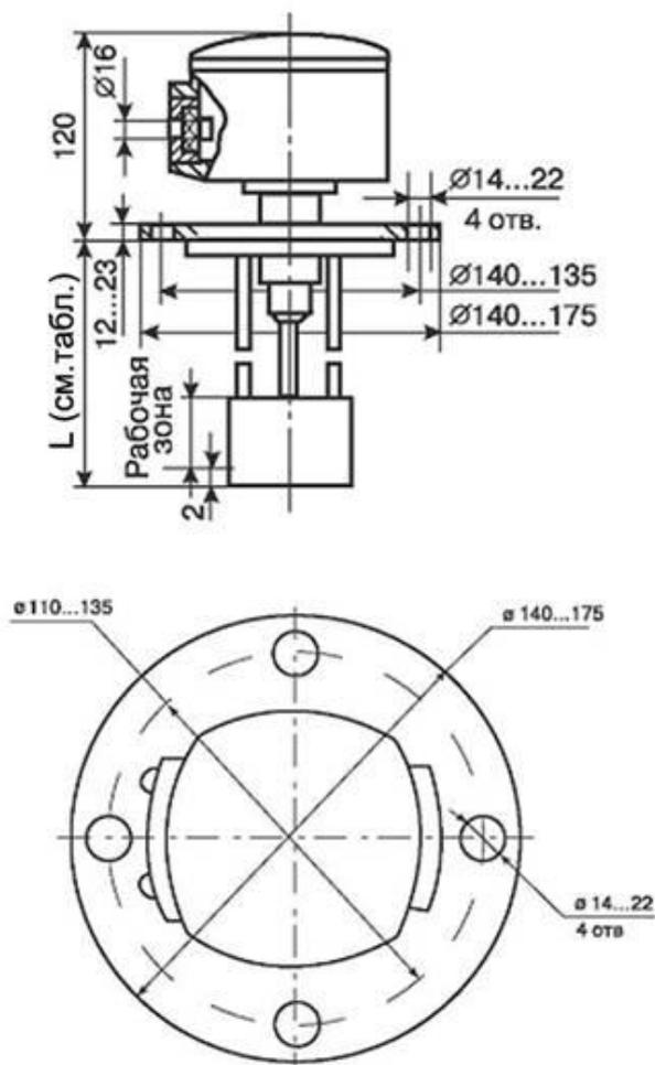
Рис. 4. Общий вид, габаритные и установочные размеры СУС-171Р(Б)
