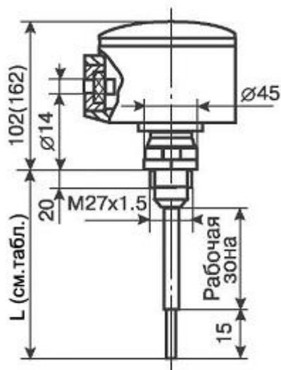
Рис. 2. Общий вид, габаритные и установочные размеры СУС-113Р(Б)
