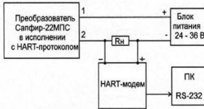
Схема подключения модема, исполнение обычное
