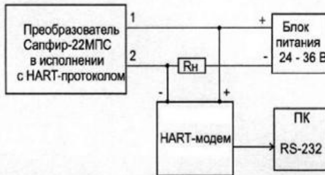
Схема подключения модема, исполнение обычное (вариант)
