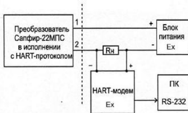
Схема подключения модема, исполнение Ex
