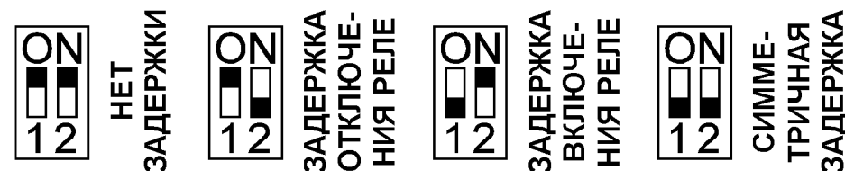
Рис. 5. Внутренние переключатели датчика.
