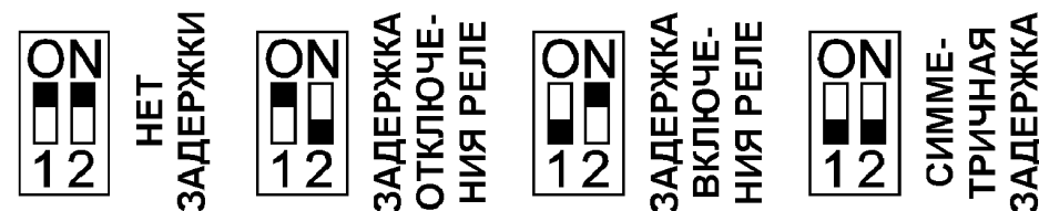
Рис. 5. Внутренние переключатели сигнализатора.
