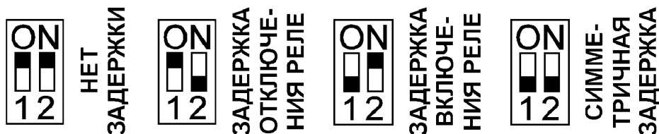
Рис. 5. Внутренние переключатели датчика.
