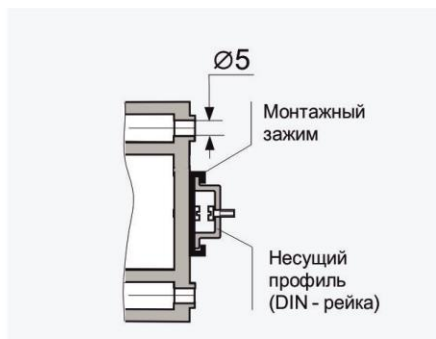
Рис. 4. Вариант исполнения прибора с монтажным зажимом для крепления на DIN-рейке.
