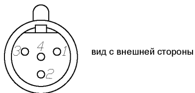
Рис.4. Нумерация контактов гнезда mini-XLR.
