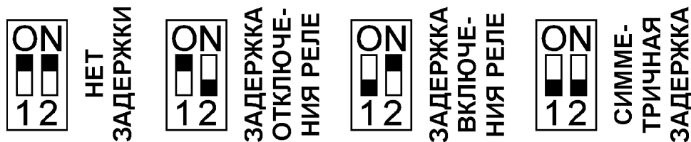
Рис. 3. Внутренние переключатели датчика.
