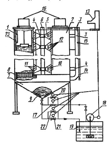
1.2. Гидравлическая часть установки содержит две измерительные трубы 1 и 2 и указательную трубку 3, которые соединены между собой через равные интервалы по высоте полыми трубками 4. Трубки 4 снабжены конусообразными переходными секциями 5, ориентированными своими основаниями в сторону измерительных труб 1 и 2.
